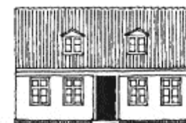
Kviste holdes mindst 3 tagsten inde fra gavle og minimum 3 tagsten over tagfod.
